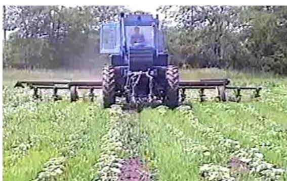
Рис.4. Трактор ХТЗ-160 в агрегаті з культиватором КРН-8,4.
