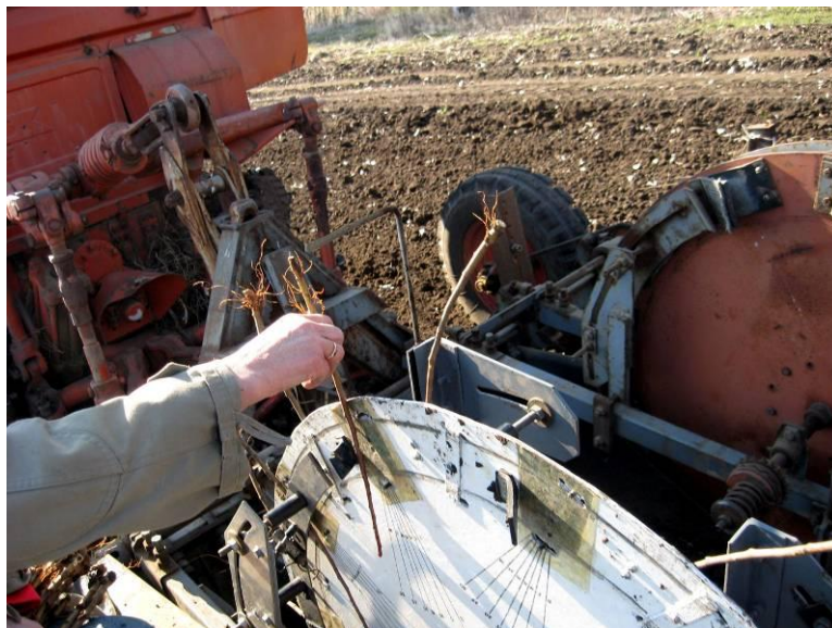
Рис. 3. Вкладання підщеп у захвати садильного апарата у процесі садіння.
