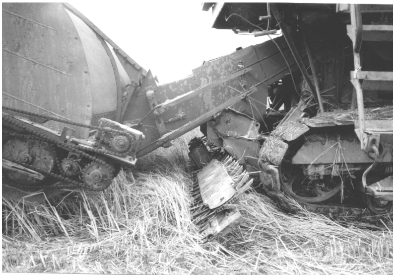
Рис.1. Різальний пристрій сегментного типу зі зворотно поступовим рухом та транспортуючим механізмом.
