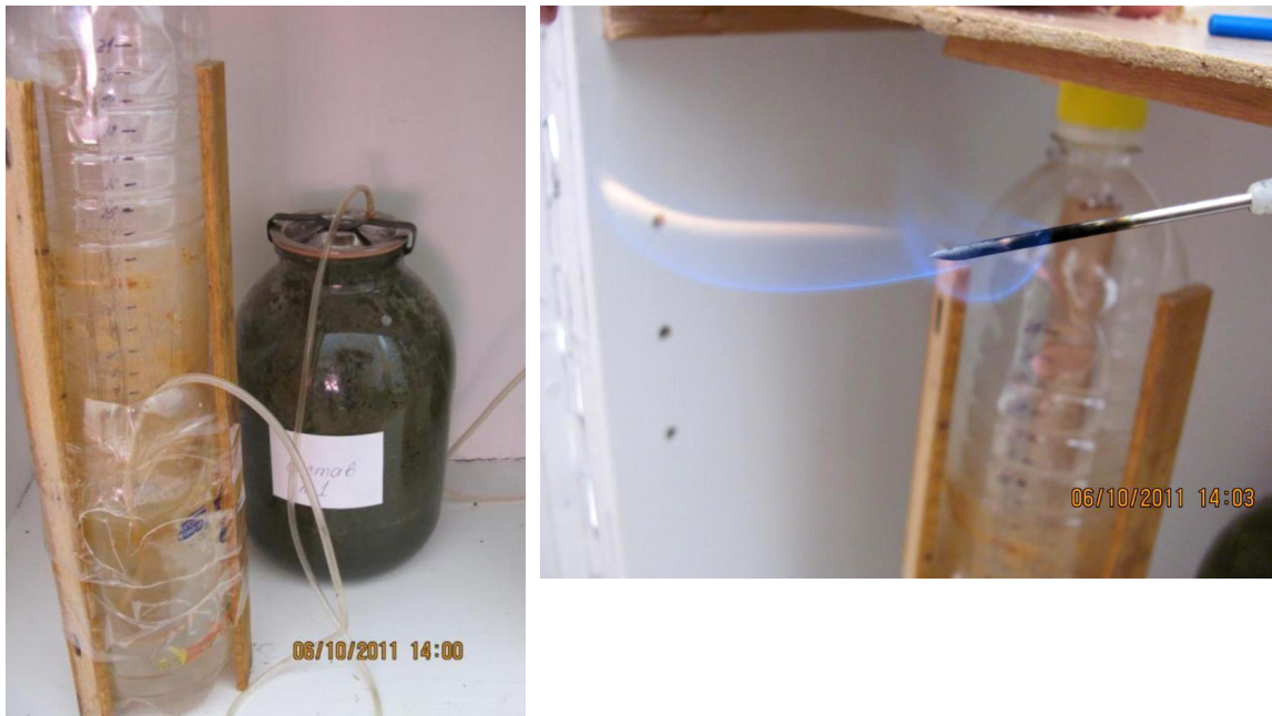
Рис. 3. Фотознімки ємностей для метаногенерації з першою сумішшю та отримане горіння біогазу.
