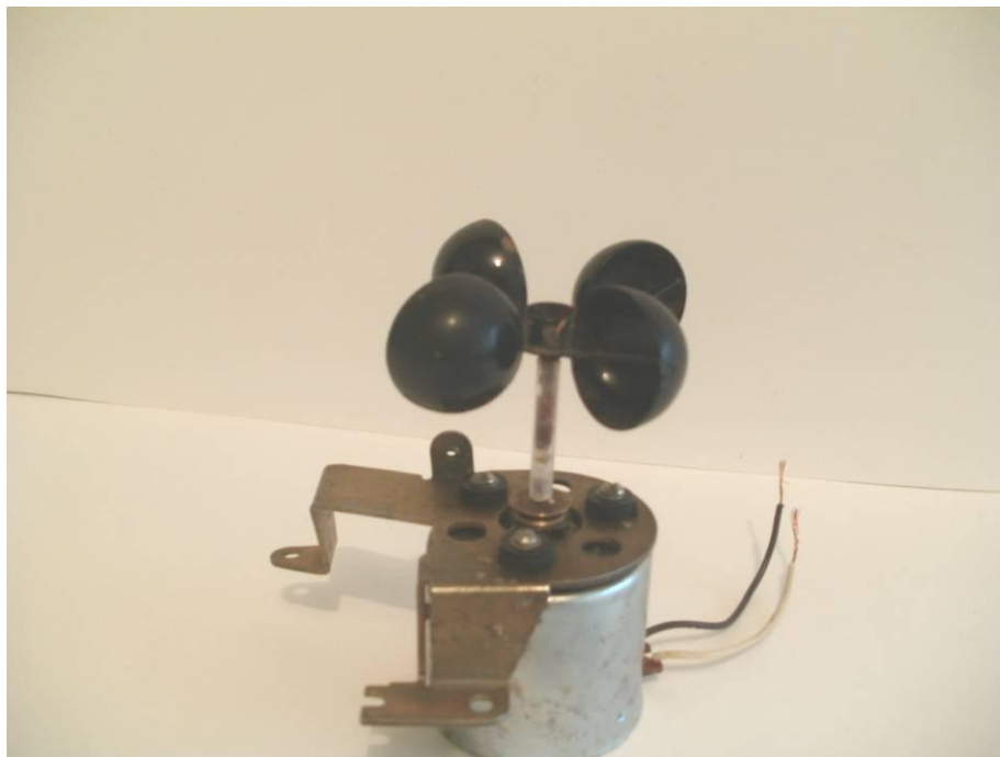
Рис. 4. Вимірювальний перетворювач швидкості вітру блоку автоматичного керування частотою обертання повітряних роторів вітроелектричного зарядного агрегату.
