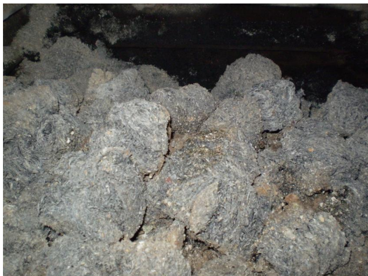
Obr. 4. Popel z topných briket vytvořených z TTP po jejich spálení.
