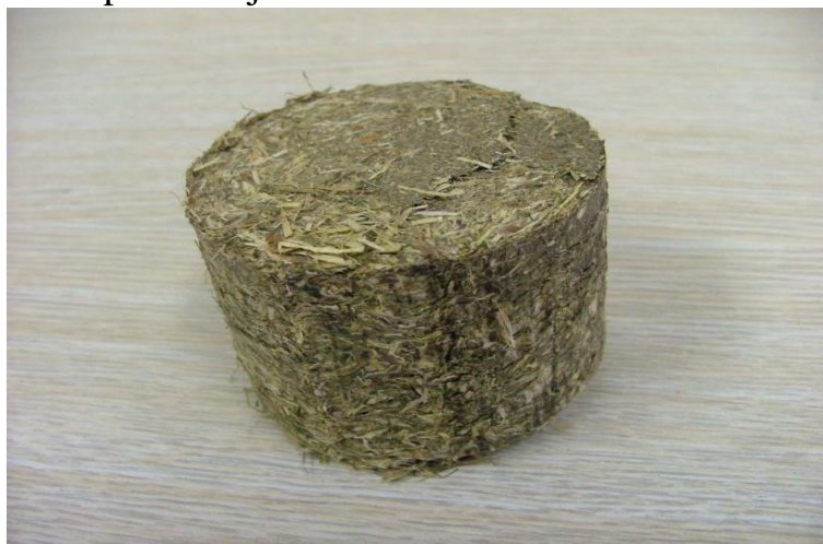
Obr. 6. Topná briketa z travní fytohmoty kombinované s topolovou štěpkou.
