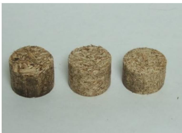
Obr. 2. Topné brikety lisované z topolové štěpky.
