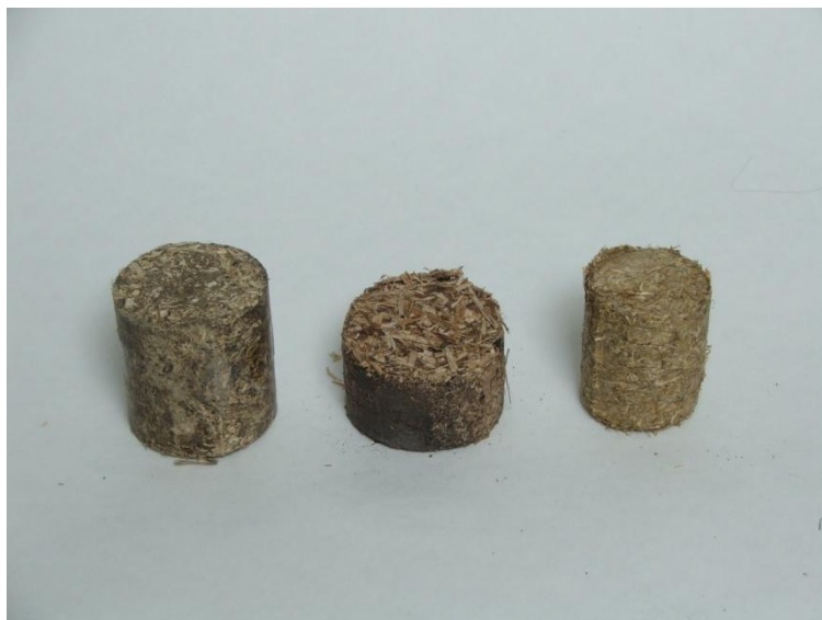
Obr. 3. Topné brikety z konopného pazdeří, z energetického šťovíku a pšeničné slámy
