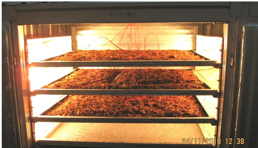
Рис.2. Сушильная камера с поддонами и высушиваемым материалом.
