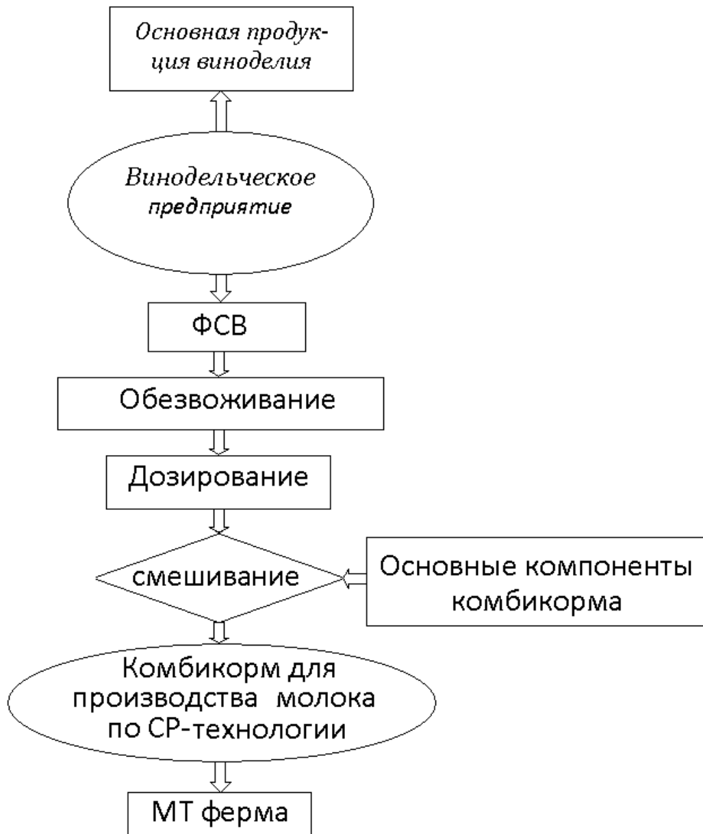
Рис.1. Схема подготовки комбикорма для производства молока по СР- технологии.
