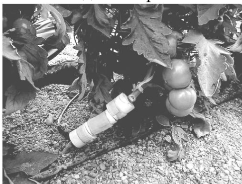
Рис. 3. Датчик водного потока, установленный на стебле.
